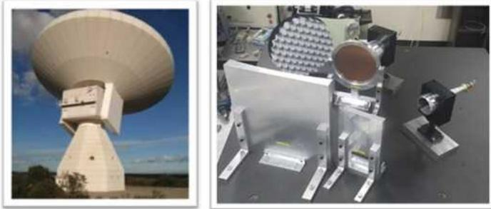
그림1. 스페인 Yebes 천문대의 직경 40m 전파망원경(좌)과 이에 설치된 22/43GHz 동시관측 수신시스템(준광학계).
