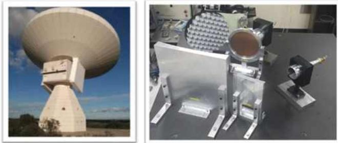
그림 . 스페인 Yebes 천문대의 직경 40m 전파망원경(좌) 및 이곳에 설치될 22/43GHz 동시관측 수신시스템.
