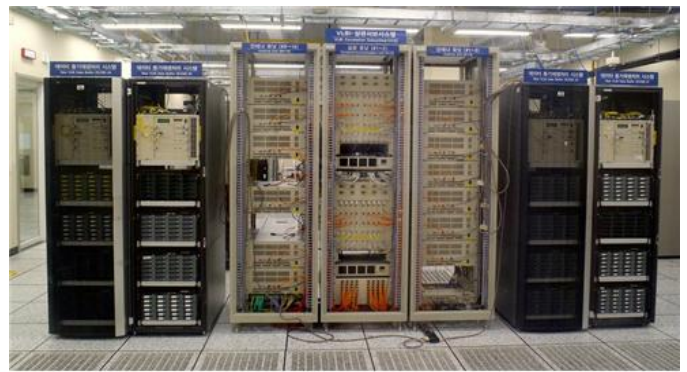
[사진 2] 대전 상관기(Daejeon Correlator, 우주전파영상합성장치)
